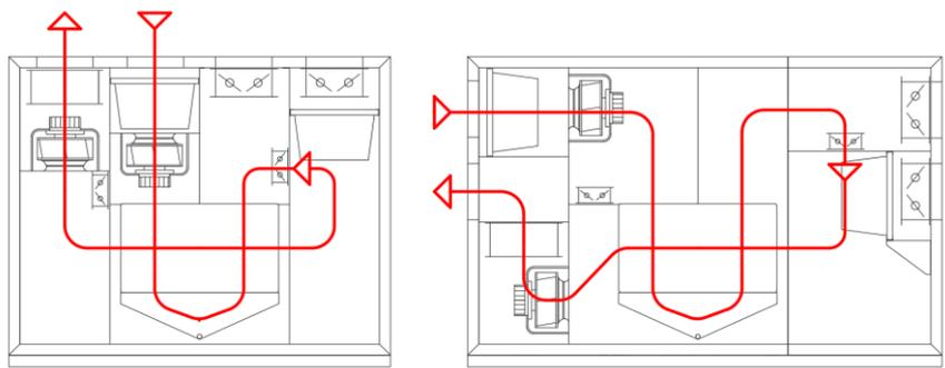
При активации происходит прогрев рекуператора теплым вытяжным воздухом, поступающим из помещения бассейна. Этот режим необходим для того, чтобы уберечь рекуператор от обмерзания.
