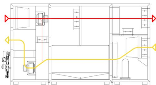
В оборудовании Hydra X (двунаправленное оборудование) опционально может быть установлен байпасный клапан (для моделей от 1500 м<sup>3</sup>/ч). Клапан предназначен для выброса вытяжного воздуха в обход рекуператора. Если температура на улице ниже, чем в бассейне, то байпас позволяет охлаждать помещение бассейна, так как воздух перестанет активно нагреваться в рекуператоре. Управляется байпасный клапан параллельно работе охладителя (даже если охладитель не применяется).
