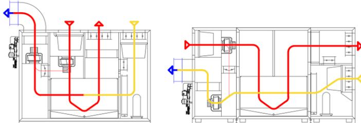
Автоматика управляет внешним ККБ по датчику температуры вытяжного воздуха. Испаритель устанавливается внешний снаружи установки. Мощность охладителя подбирается индивидуально. Управление ККБ On/Off с настраиваемым гистерезисом.
