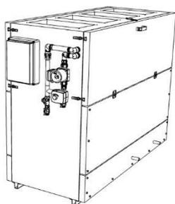
Корпус включает в себя основной периметр, условно несъемные и сервисные двери, поддон рекуператора, воздушные клапана. Через сервисные двери производится регулярный сервис: замена фильтров, осмотр и проверка вентиляторов, теплообменников, воздушных клапанов. Толщина тепло-звукоизоляции – 50 мм. Конструкция с минимальным количеством мостиков холода позволяет минимизировать уровень шума и исключить промерзание корпуса.
