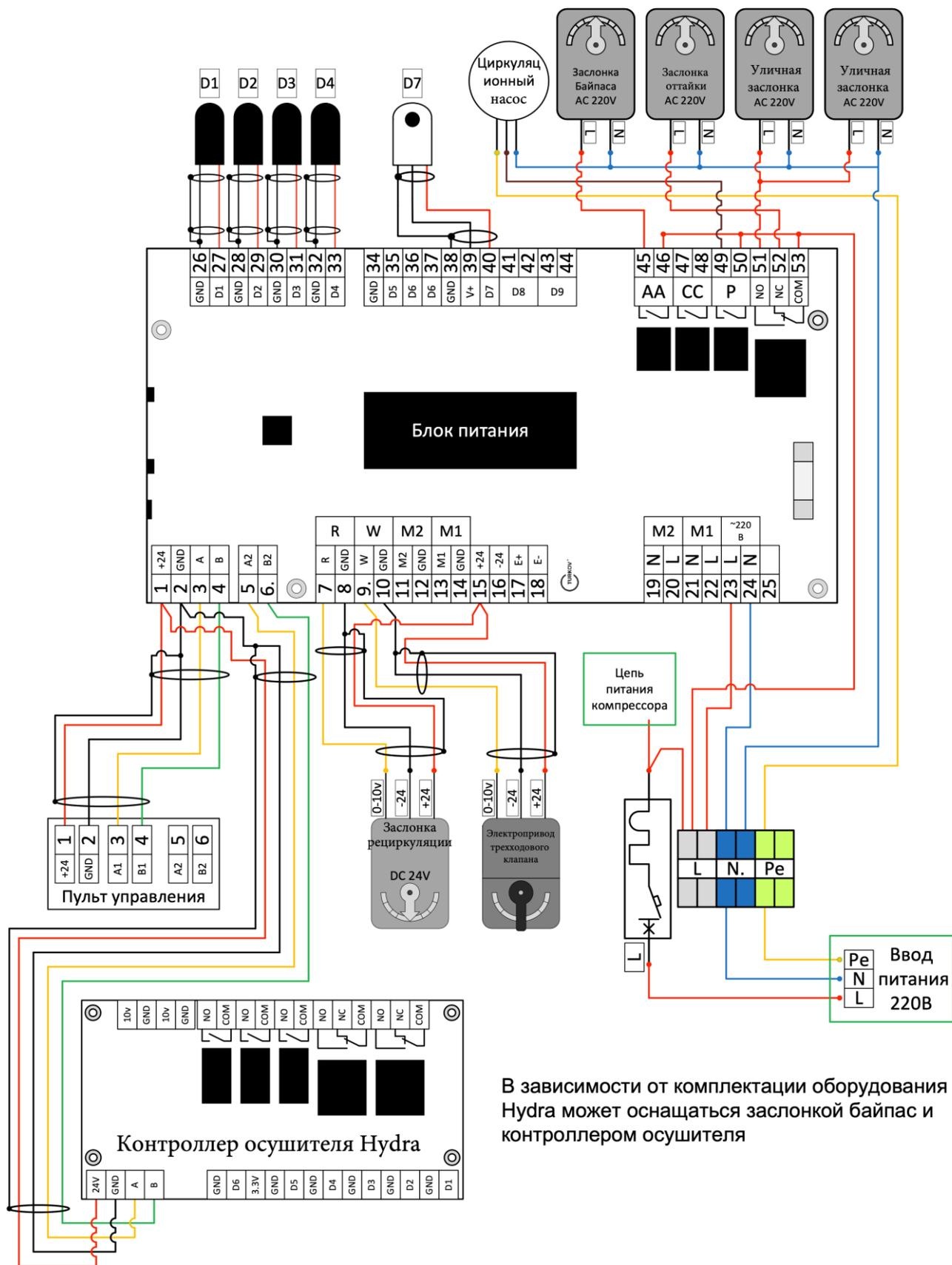
В зависимости от комплектации оборудования Нудра может оснащаться заслонкой байпас и контроллером осушителя
