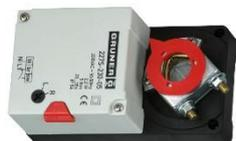
Внутренние воздушные заслонки снабжаются компактными и надежными электроприводами. На приводе есть кнопка расцепления привода и основной оси, что позволяет вручную проверить работу воздушных клапанов.
