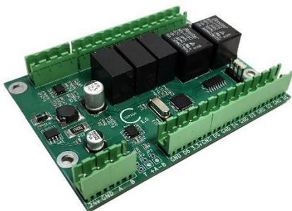
В оборудовании применяются отдельный контроллер управления компрессорным осушителем. Автоматика отслеживает температуру испарителя и конденсатора, время работы компрессора, предупреждает о нештатных ситуациях, управляет работой компрессора и соленоидного вентиля. Температура теплообменников отображаются на пульте управления. Все настройки работы осушителя и защиты компрессора производятся с пульта управления.
